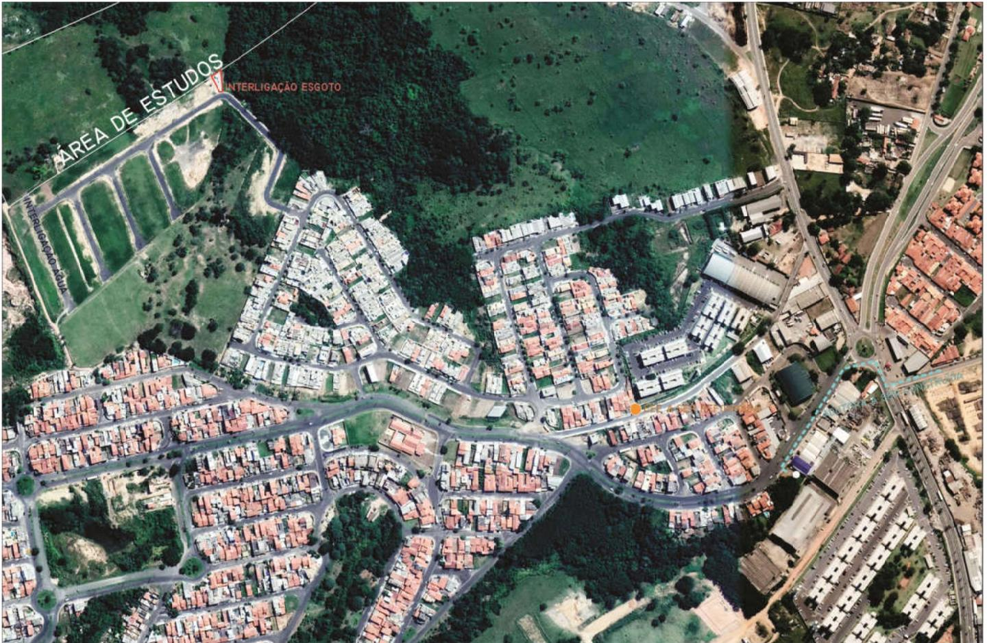
**FIGURA 3.** Intervenções externas – pontos de ligação das redes de água potável (azul escuro) e esgotamento sanitário (vermelho), trecho de adução de água potável (azul) a ser construída e EEE a ser reformada (laranja).
