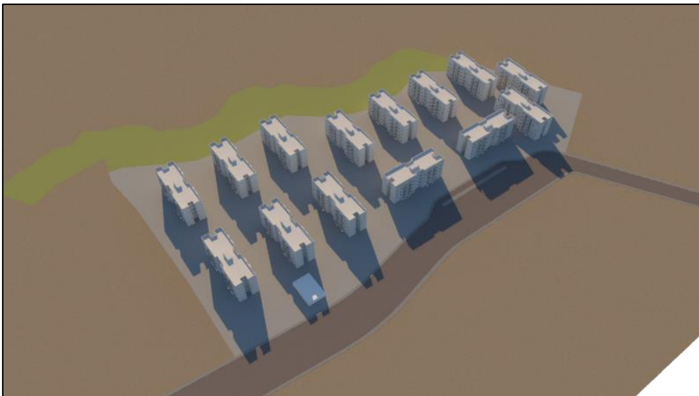
Imagem 8: Estudo de Insolação no período do inverno, as 09h00min horas em vista topo e perspectivas.
