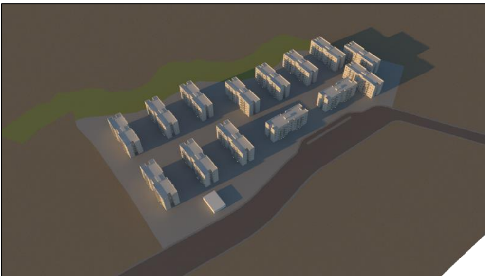
Imagem 12: Estudo de Insolação no período do inverno, as 17h00min horas em vista topo e perspectivas.
