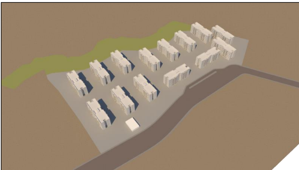
Imagem 5: Estudo de Insolação no período do verão, as 15h00min horas em vista topo e perspectivas.
