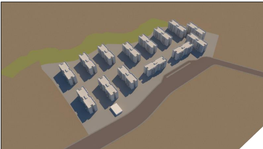
Imagem 2: Estudo de Insolação no período do verão, as 09h00min horas em vista topo e perspectivas.
