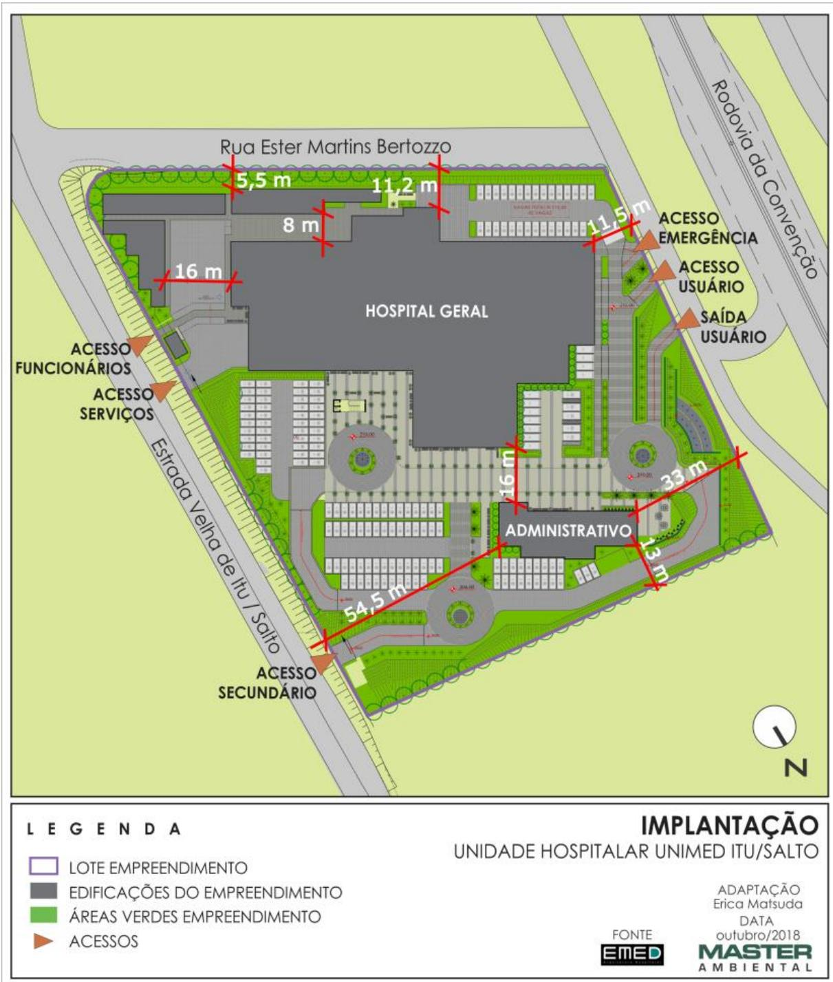
**Figura 43: Implantação do empreendimento com recuos. Fonte: Projeto Arquitetônico (adaptado).**
